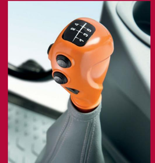
Schalthebel mit Powershift-Tasten und Taste der elektrohydraulischen ComfortClutch-Kupplung
