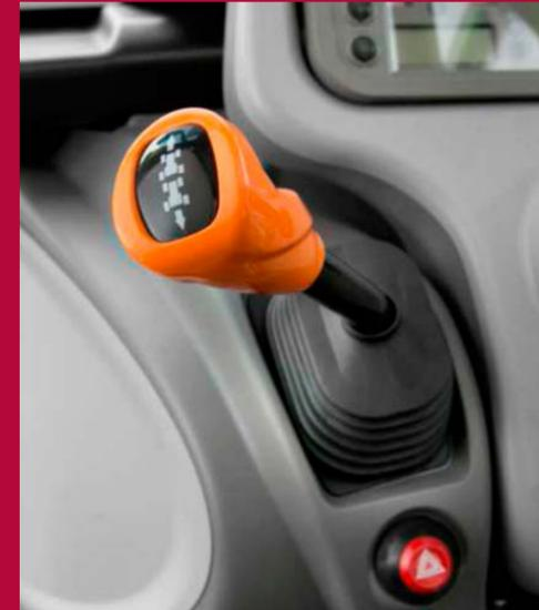
Mechanisches Wendegetriebe mit neuem Bedienelement unter dem Lenkrad
