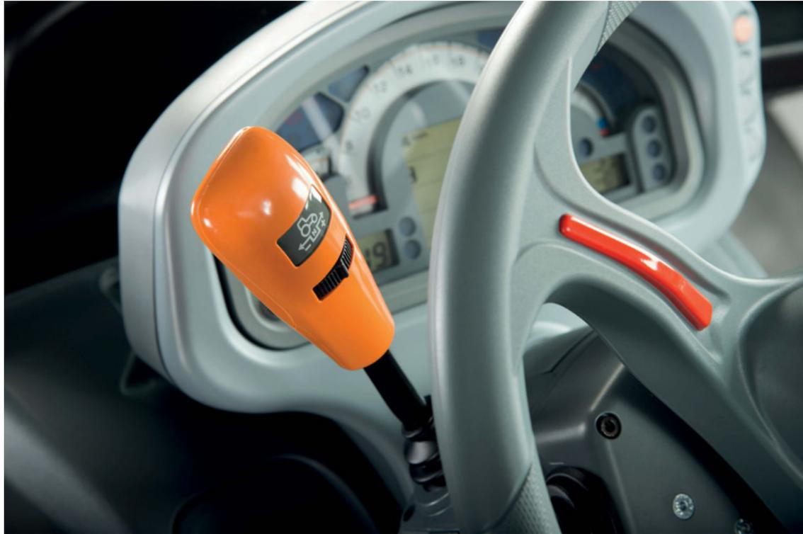
Der Hebel des hydraulischen Wendegetriebes verfügt über ein praktisches Bedienelement zur Regelung des Ansprechverhaltens beim Richtungswechsel. Durch Betätigung kann das Ansprechverhalten in 5 verschiedene Stufen moduliert werden.
