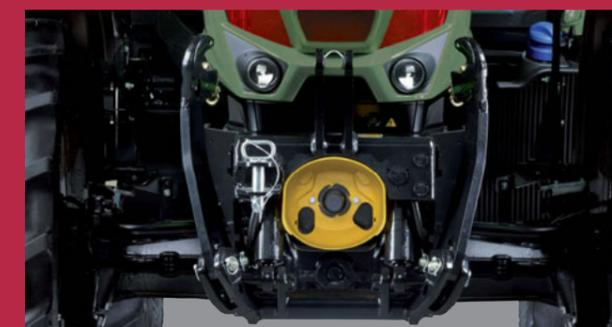
Leistungsstarker Frontkraftheber mit bis zu 2.880 kg Hubkraft. Komfortpaket mit einem Zusatzsteuerventil in der Front verfügbar. 1000 U/min Frontzapfwelle auf Wunsch.
