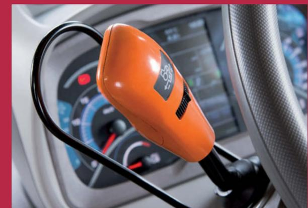
Powershuttle mit fünfstufig vorwählbarem Ansprechverhalten für den Fahrtrichtungswechsel ohne Drehmomentunterbrechung.
