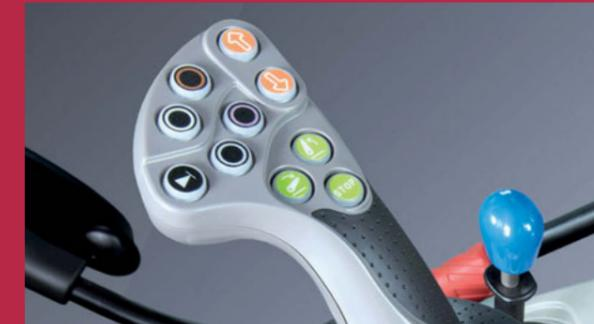
Die Bedienung der V-Drive-Modelle erfolgt über den neuen MaxCom Joystick. Vier Knöpfe sind frei belegbar.
