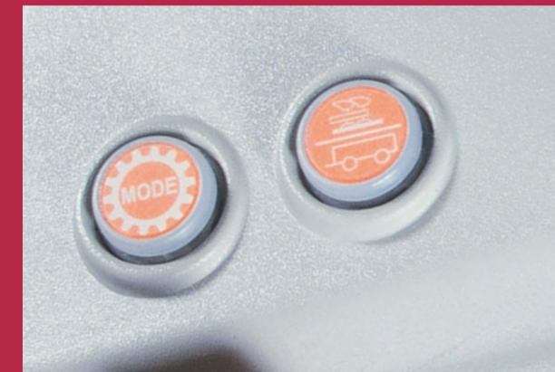
Zwei Arbeitsbereiche, Feld und Transport, elektrohydraulisch schaltbar.
