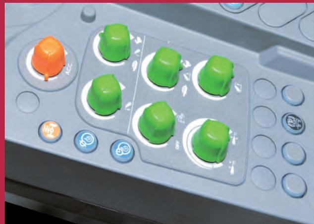
Die Feineinstellung von Frontkraftheber (nur V-Drive) und Heckkraftheber erfolgt über entsprechende Potenziometer in der Armlehne.
