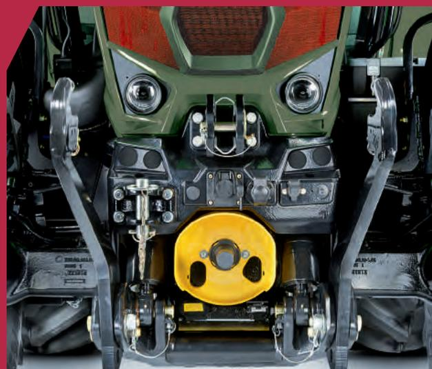
Neuer, positionsgesteuerter Frontkraftheber (V-Drive Modelle) mit bis zu 5.480 kg Hubkraft.
