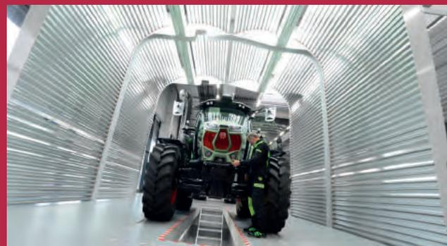
Vor der Auslieferung durchlaufen die XL<sup>PRO</sup> noch einen Lichttunnel. Hier wird ein 360° Check durchgeführt, welcher die höchstmögliche Qualität sicherstellt.
