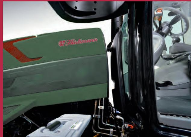
Kabine und Motorhaube sind für maximalen Komfort voneinander entkoppelt. Dies reduziert deutlich Lärm und Vibrationen.
