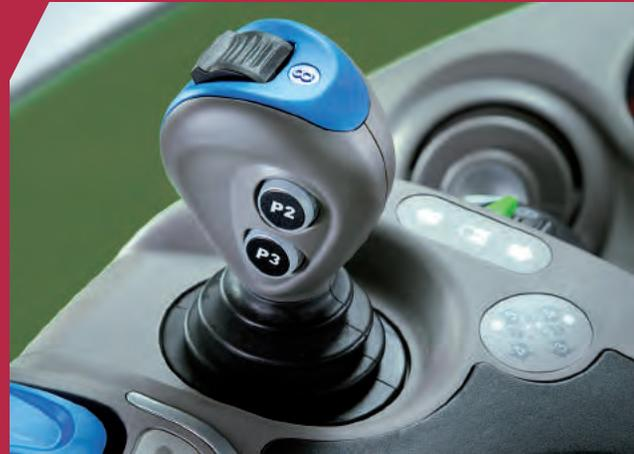
Die Hydraulikventile sind proportional steuerbar und voll auf Zeit und Menge programmierbar. Der elektronische Joystick kann programmiert werden, um den Frontlader zu bedienen, weitere Steuerventile können über das Rändelrad bedient werden.
