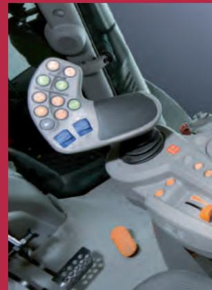
RCshift: Variante mit mechanischen Steuergeräten oder mit Multifunktionsarmlehne mit elektrohydraulischen Steuerventilen und optionalen iMonitor.
