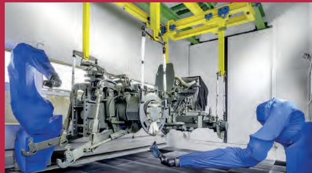
Die hochmoderne Lackieranlage arbeitet in 5 Stufen. Um maximalen Schutz vor Korrosion zu erhalten, wird der Rumpf erst grundiert und dann lackiert. Und dank elektrostatischer Aufladung wird eine gleichmäßige Lackdicke gewährleistet.
