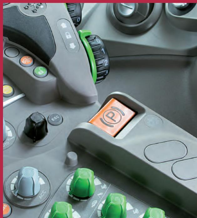
Bei den V-Drive Modellen ersetzt eine elektronische Handbremse (EPB) den mechanischen Handbremshebel und wird über eine elektrische Tastensteuerung an der Armlehnenkonsole betätigt. Als zusätzliches Sicherheitsmerkmal aktiviert sich die EPB automatisch, sobald der Fahrer für eine gewisse Zeit den Sitz verlassen hat.
