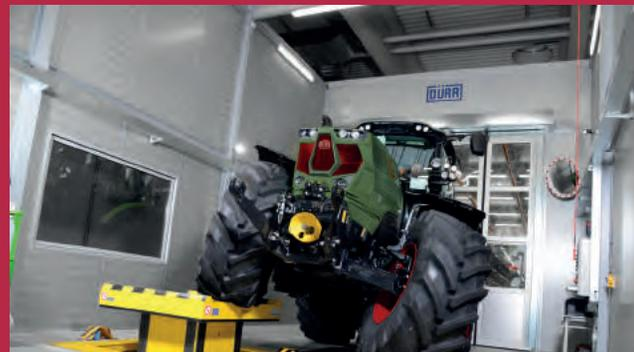
Noch vor dem Lichttunnel durchlaufen alle Traktoren einen Prüfstand mit Dynamik-, Rollen-, Bremsen- und Pendelhubtest. Letzterer sorgt für maximalen Lenkeinschlag bei allen ausgelieferten Traktoren.
