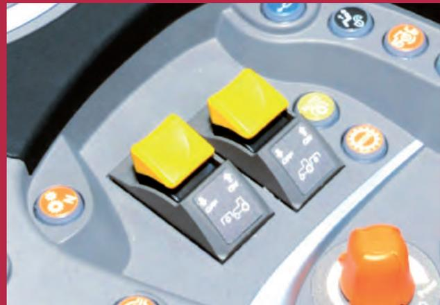
Bei allen Kabinenausführungen erfolgt die Zapfwellenschaltung standardmäßig einfach und sicher per Tastschalter.
