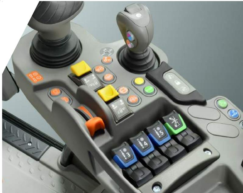
Bei Arbeiten mit Frontanbaugeräten bleibt die linke Hand am Lenkrad und die Rechte bedient den Joystick. Hier sind die Steuerung der Fronthydraulik, die Steuerung der Fahrgeschwindigkeit und diverse programmierbare Funktionen, wie der Fahrtrichtungswechsel oder die Frontkrafthebersteuerung zusammengefasst und über drei frei programmierbare Tasten bedienbar.
