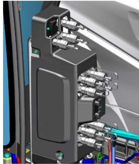
Bis zu 4 doppeltwirkende Steuergeräte in der Front sowie 3 duplizierte Heckanschlüsse und 2 drucklose Rückläufe
