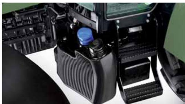
Un réservoir à carburant contenant jusqu'à 145 litres et 10 litres d'AdBlue permettent de longues périodes de travail. (en fonction du modèle)
