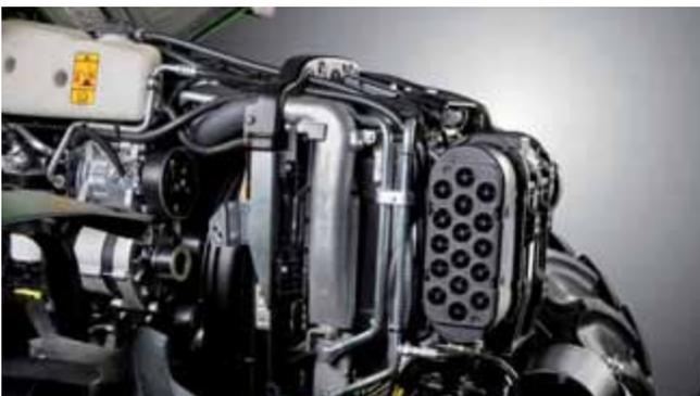
Le filtre à air PowerCore supporte l'efficacité du moteur...
