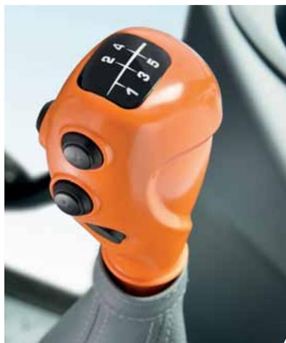
Levier de changement de vitesse par boutons d'embrayage ComfortClutch et Powershift.
